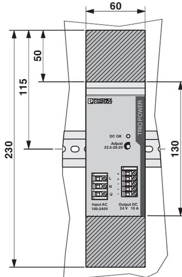
Posición de montaje: Profundidad de montaje 152,5 mm (+ carril)
