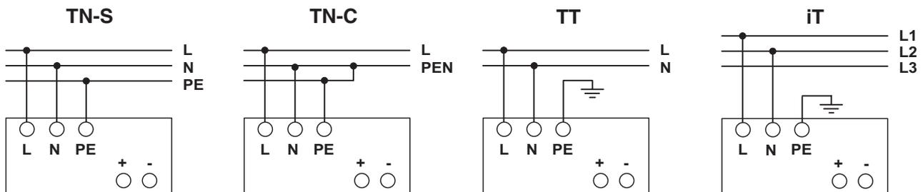
La conexión de 100 V AC ... 240 V AC se efectúa a través de las conexiones por tornillo L, N y PE.
