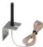
Antena omnidireccional, 2,4 GHz, ganancia: 2 dBi, polarización: lineal, ángulo de apertura: h/v 360°/75°, índice de protección: IP65, conexión: RSMA (macho), incl. cable de conexión de 1,5 m y soportes de montaje para montaje mural
