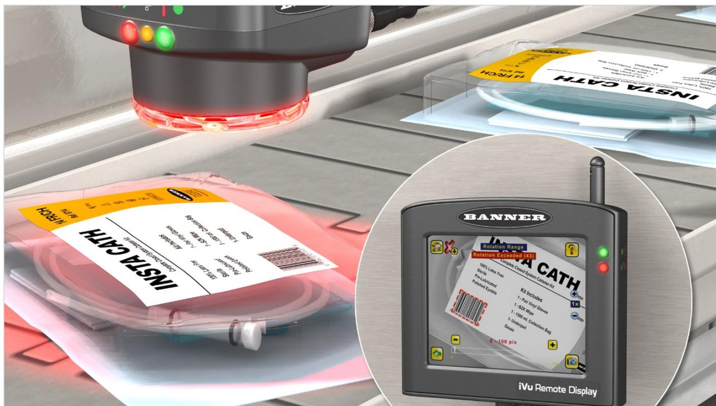
*El lector de códigos de barras de la serie iVu BCR con detección de rango de rotación lee el código de barras en el empaque del producto médico y verifica que el paquete esté correctamente alineado para el sellado térmico.*
