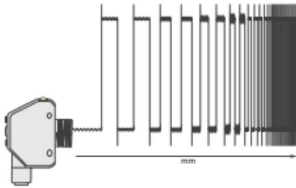
La tecnología Pulse Pro permite a un sensor discreto con salida PFM funcionar como un sensor analógico compartiendo la información de su medición y posicionamiento en tiempo real.
